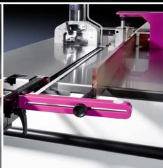
Штамповка токовых шин, выдвижная измерительная система
