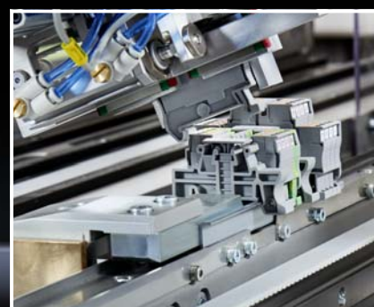
Автоматизированная комплектация клеммных реек и маркировка с помощью лазерной системы
