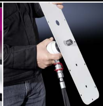
Создание вырезов в стали и нержавеющей стали (комплектующие: гидравлический шланг и цилиндр, см. страницу 645)
